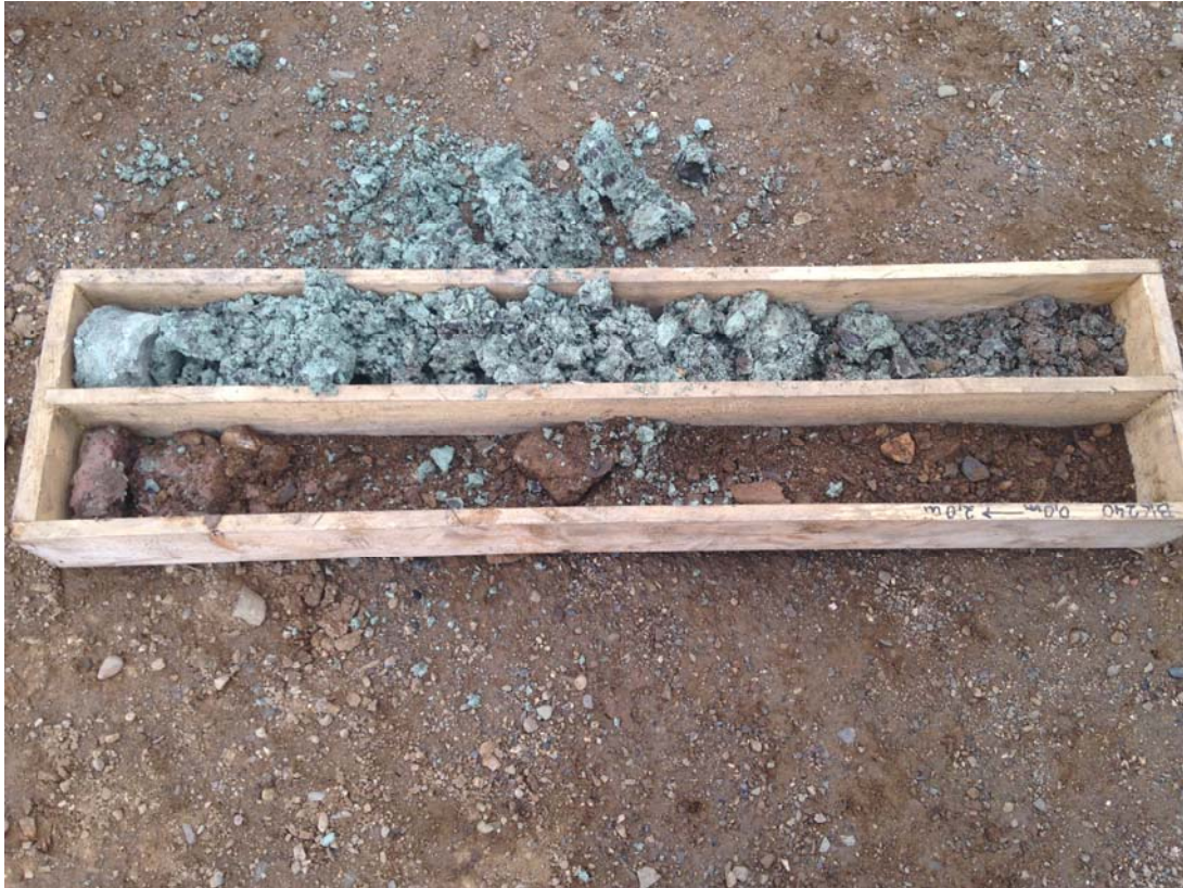
Bild 4: Bohrpunkt BP2, Grobkies im Vordergrund und verwitterten Tonstein (grün)
