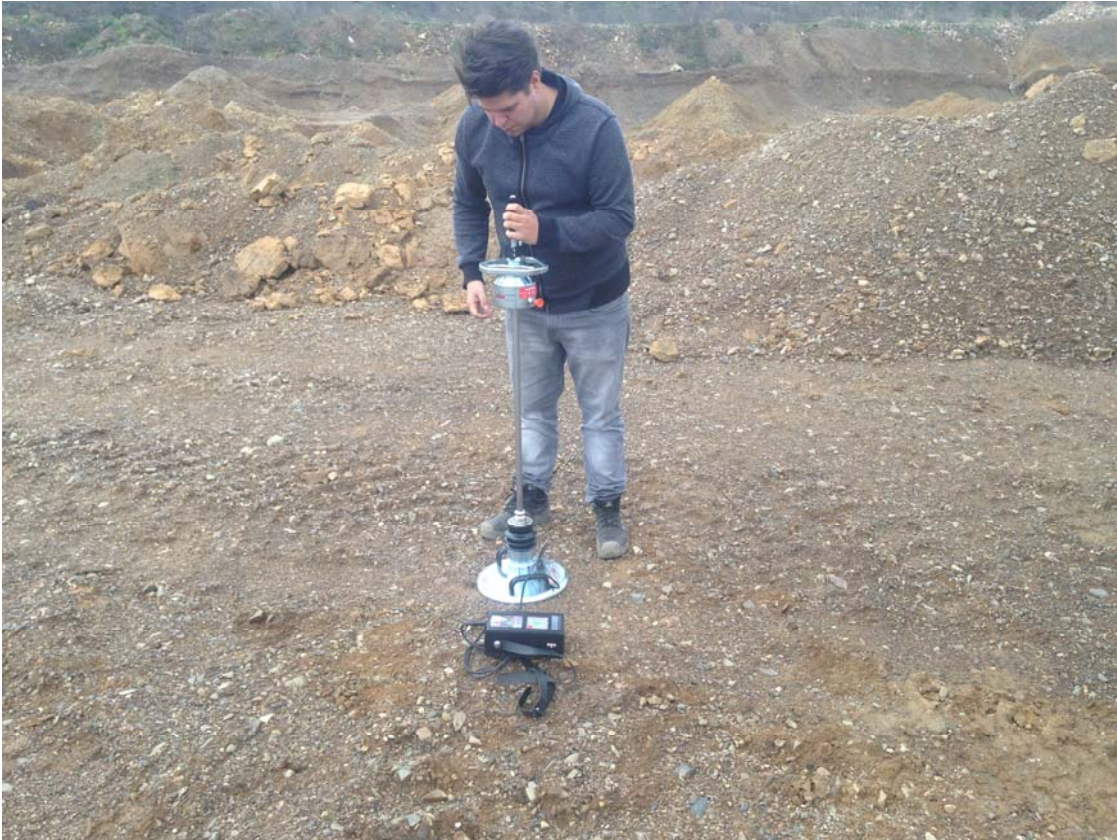
Bild 6: Tragfähigkeitsprüfung im Bereich des BP2 (Liegendes)
